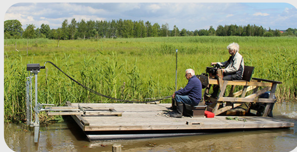
Moottoriveneen keulaan tai lauttaan asennettavat leikkurit
